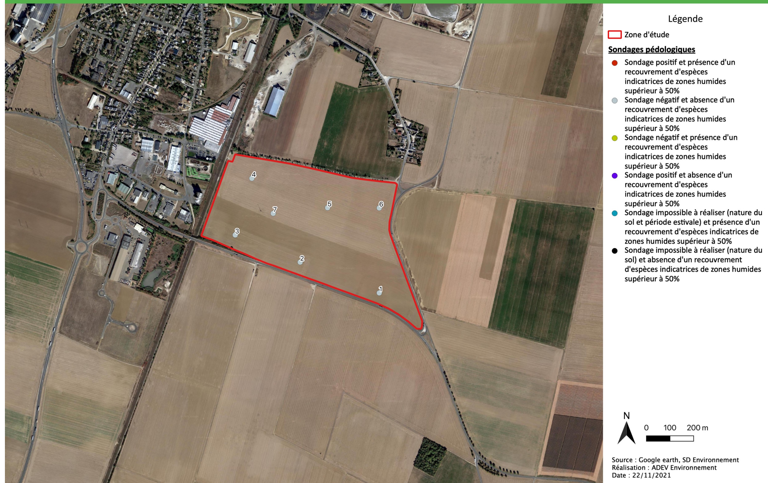
Carte 11 : Localisation des sondages pédologiques (Source : SD Environnement, ADEV Environnement)
